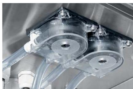
Точная дозировка до миллилитра: дозировочный насос точно и экономно измеряет как кислотные, так и щелочные моющие средства (опция – третий дозировочный насос для дезинфекции).
