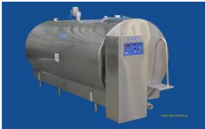
Танки-охладители с системой 4 надоя предназначены для охлаждения молока в 4 партиях (отбора молока в первый и третий день). Применённый агрегат охлаждает 1\4 ёмкости резервуара за 3 часа (max) от температуры 35°C до температуры 4°C (время охлаждения первой партии молока меньше чем 2,5 часа).
