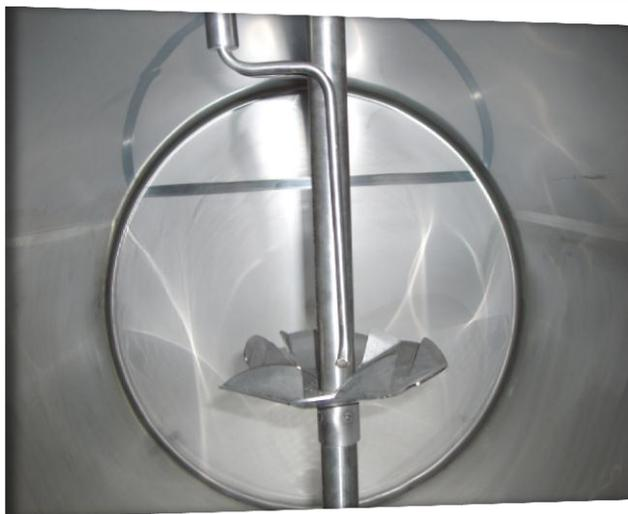
По двум тонким трубкам вода с высокой скоростью поступает из верхней части ёмкости на вращающийся распылитель, установленный на вале мешалки, таким образом разбрызгивая её по внутренним стенкам ёмкости.
