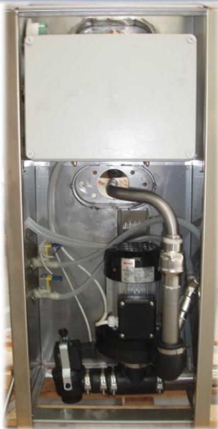
Процесс мытья состоит из пяти циклов, как и в полностью автоматической системе промывки. Дозирование щёлочи и кислоты контролируется 3-позиционным переключателем, расположенным на левой стороне панели вместе с перистальтическими насосами. На системе промывки ECO не установлены датчики уровня воды и щёлочи/кислоты, поэтому все циклы процесса мытья контролируются только временем.
