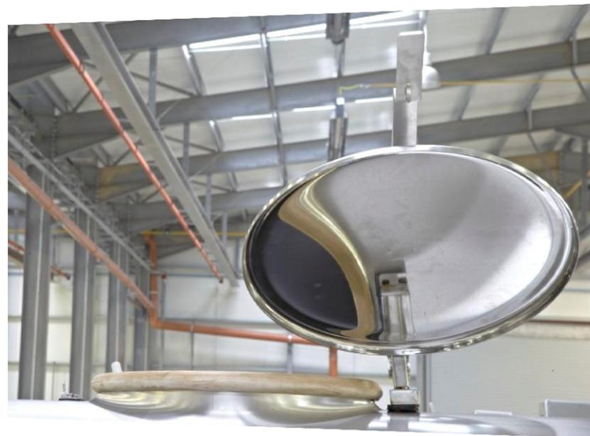
Люк диаметром  $\text{Ø}400\text{mm}$  для моделей до 3000л
