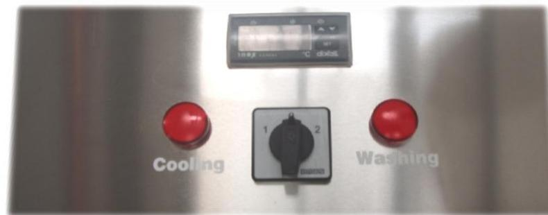
Простая автоматическая (PLC) система управления оснащена всеми необходимыми элементами для эффективного охлаждения и промывки танков-охладителей молока.
